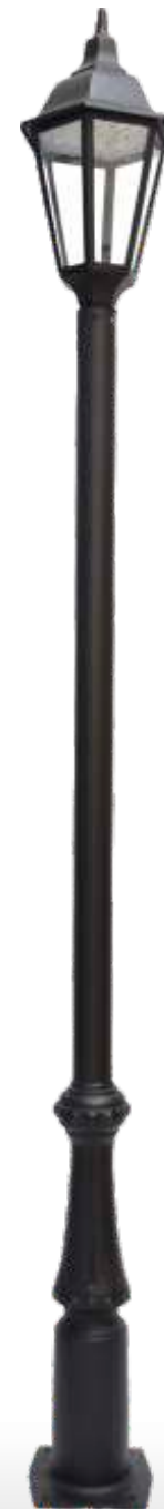
POSTE VITÓRIA C/ 01 LUMINÁRIA ITALIANA PT 304 Alt. Total: 3,36 m Base: 25 x 25 cm Tubo: 3" Quant. Módulos Led: 1 Potência 50 W Possui Janela de Inspeção
