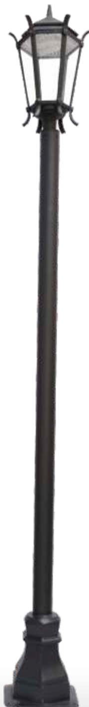
POSTE MILANO C/ 01 LUMINÁRIA FRANCESA PT 313 Alt. Total: 4,07 m Base: 37 x 32 cm Tubo: 4" Quant. Módulos Led: 2 Potência 100 W Possui Janela de Inspeção
